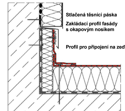
Pevné připojení na izolovanou zeď
