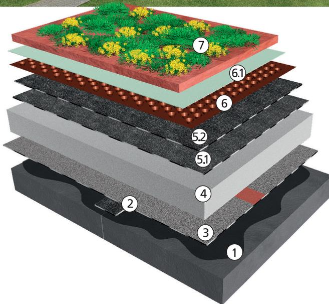
Konstruktion: **Warmdach – nicht belüftetes Dach – extensiv begrünt**
