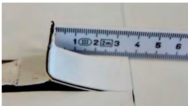
Ideális szakadás \geq 2 cm-es fugaszélességnél a Polyfin Duo lemez példájával
